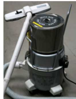
クリーンルーム用の ULPA フィルタ つきの掃除機で清掃している。
